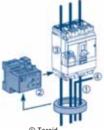
① Toroid ② Vigirex röle ③ MX bobini ④ Nötr
