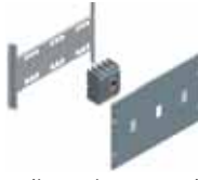
Dikey şalter montajı
