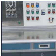
AG Devre Kesici Ani Açma Testi
