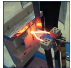
Termo-Plastik Malzeme Kızgın Tel Testi
