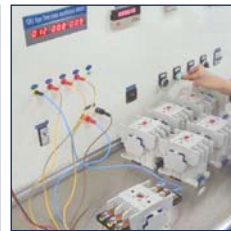
AG Kontaktörleri Bobin Çalışma Karakteristiklerinin Kontrolü
