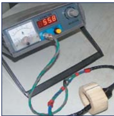
Akım Transformatörleri Nüve Testi
