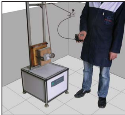
TS EN 61008-1 madde 9.12 'ye göre yapılan mekanik darbelere dayanım deneyi
