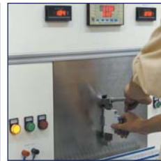
Otomatik Sigorta Ani Açma Testi
