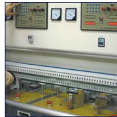
Otomatik Sigorta Aşırı Akım Salıcılarının Kalibrasyonu
