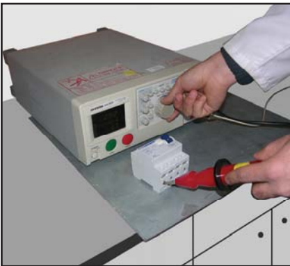
TS EN 61008-1 madde 9.7 'ye göre yapılan dielektrik özellikleri ve ayırma yeteneği deneyi
