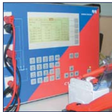
Akım Transformatörü Sınıf Doğrulama Testi
