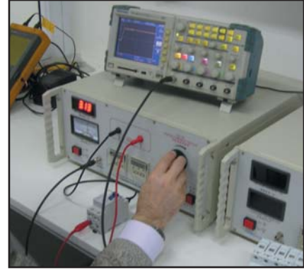
TS EN 61008-1 madde 9.19.2'ye göre yapılan 8/20 μs akım dalga deneyi (tepe akımı 3000 A)
