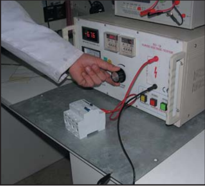
TS EN 61008-1 madde 9.20 'ye göre yapılan 1,2/50 μs darbe dayanım gerilimi deneyi (tepe gerilimi 8 kV)
