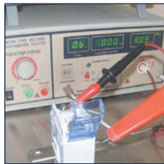
Akım Transformatörü İzolasyon Testi
